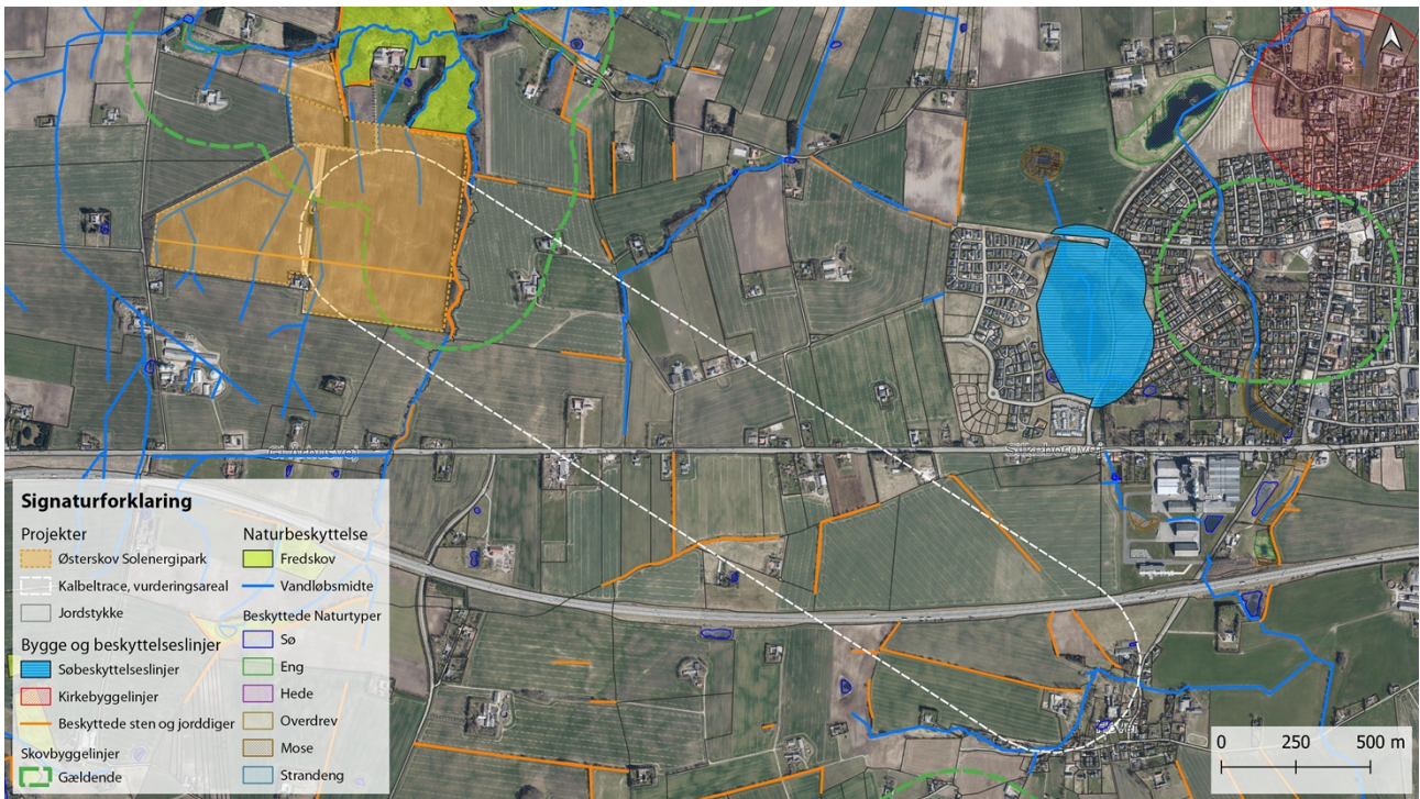
Figur 7. Mulig placering af kabeltracé inden for en 600 m bufferzone. Diger, vandløb og andre beskyttede områder er vist.
